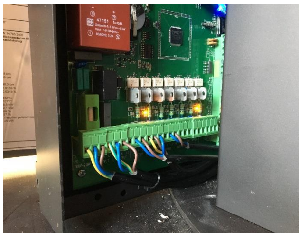
Vyjmutí základní řídicí desky z Aduro Hybrid
