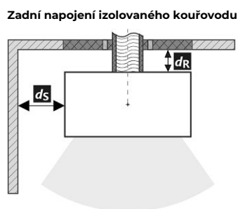
Prostup kouřovodu stěnou z hořlavé hmoty ČSN 06 1008
