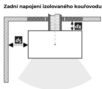
Prostup kouřovodu stěnou z hořlavé hmoty ČSN 06 1008
