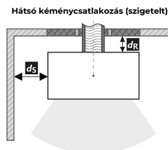
A füstcső áthaladása éghető anyagból készült falon
