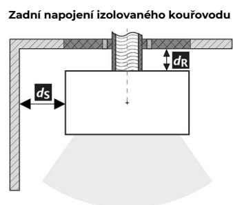
Prostup kouřovodu stěnou z hořlavé hmoty ČSN 06 1008
