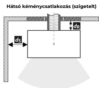
A füstcső áthaladása éghető anyagból készült falon
