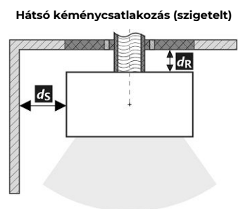
A füstcső áthaladása éghető anyagból készült falon
