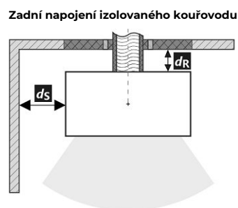
Prostup kouřovodu stěnou z hořlavé hmoty ČSN 06 1008
