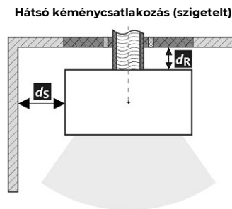
A füstcső áthaladása éghető anyagból készült falon
